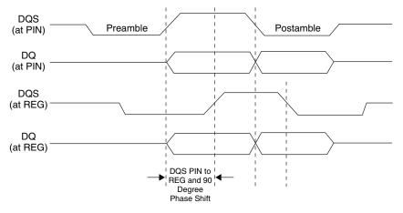
Figure 11-4. DQ-DQS During WRITE
